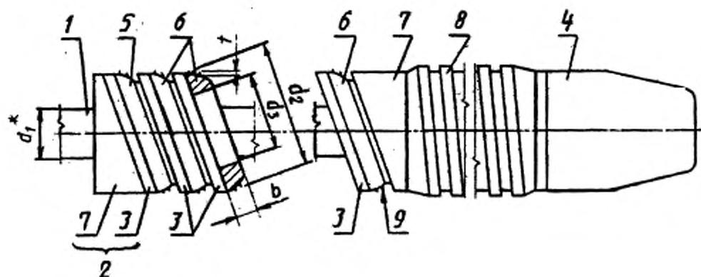
\* Диаметр оси  $d_1 = 10$  мм.
