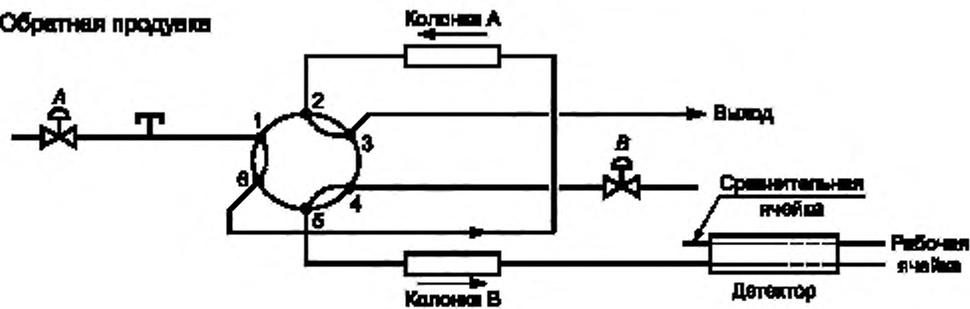
Рисунок 2 — Обратная продувка с переключением клапанов
