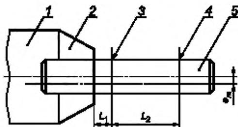
1 — приводной шпиндель (хвостовик зажимного устройства); 2 — зажимное устройство; 3, 4 — точки измерения биения;
