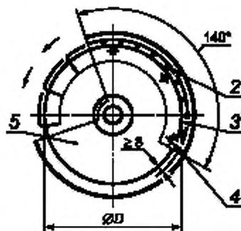
1 — основное ограждение; 2 — стопорящий штырь; 3 — внутренние ограждения; 4 — крепежный винт; 5 — шлифовальный круг
