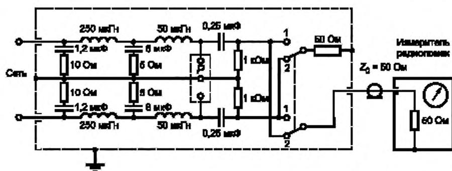
*P* — разъем для подключения испытуемого устройства
