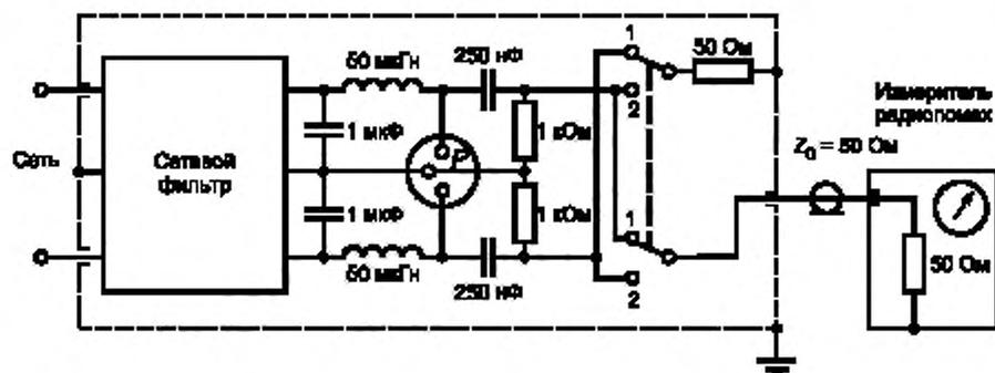
P — разъем для подключения испытуемого устройства
