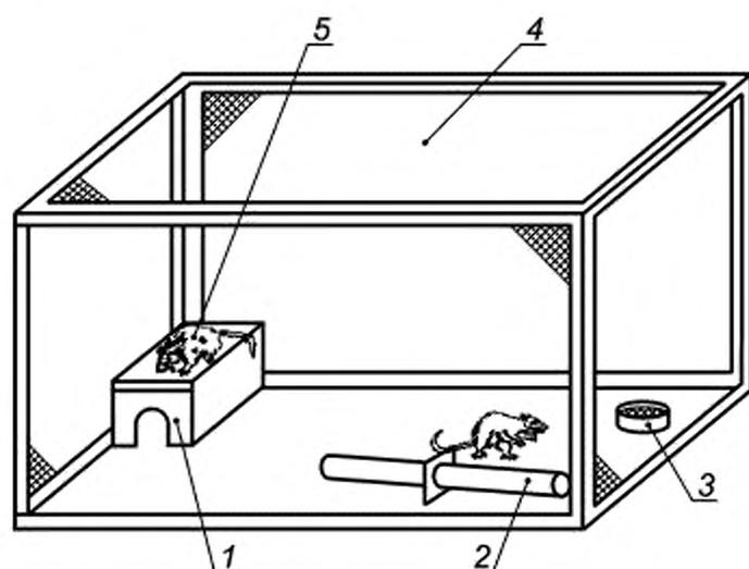
1 — укрытие из любого материала; 2 — труба из непрогрызаемой пластмассы; 3 — глиняная или пластмассовая кормушка;
