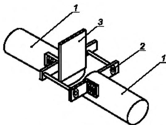
1 — труба; 2 — зажимы (винты); 3 — испытуемый образец
