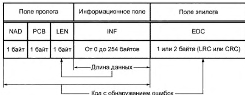
Рисунок 16 — Структура блока
