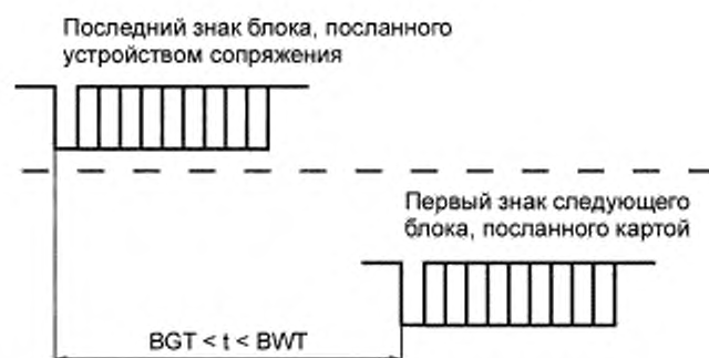
Рисунок 21 — Время ожидания блока и разграничительный интервал блока
