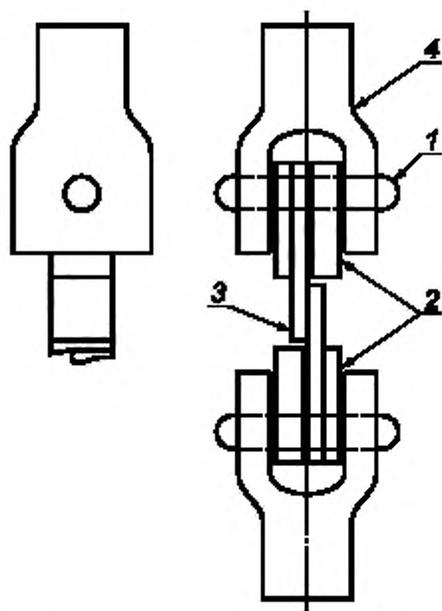
1 — осевая шпонка; 2 — разделительная прокладка; 3 — соединенный образец; 4 — вилка
