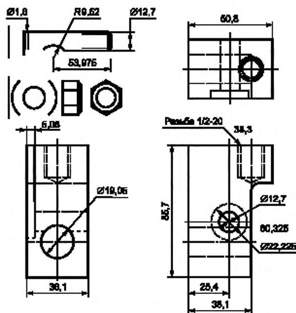
Рисунок 1 — Типовое зажимное приспособление для испытания на сдвиг
